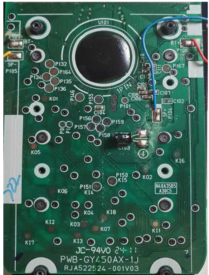
Figure 6: Die Leiterplatte eines Taschenrechners FX-85DE PLUS von Casio. Hier ist bei Komponente U101 des PCB ein Chip-On-Board Package verwendet worden
