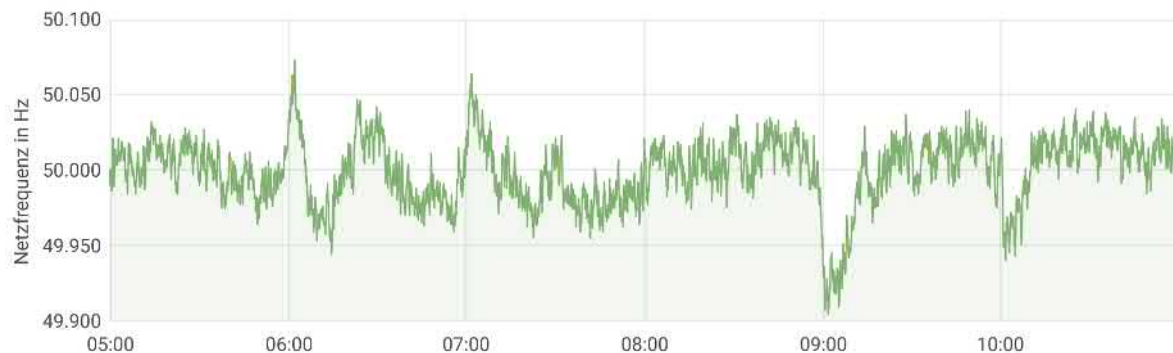
Abbildung 4.12: Visualisierung des Verlaufs der Netzfrequenz über 6 Stunden des Morgens des 29. März
