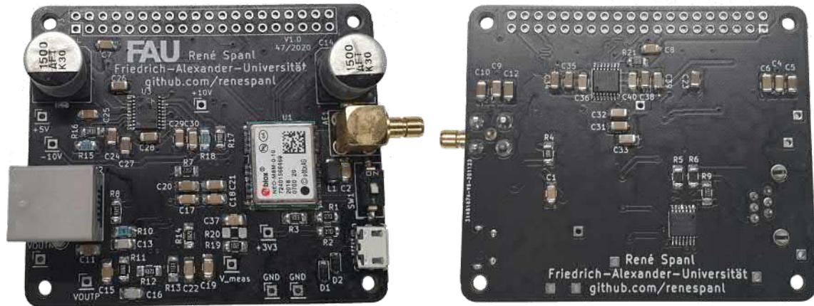
Abbildung 3.12: Fotografie der bestückten HAT-Platine, Oberseite links, Unterseite rechts zu sehen
